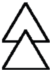
Afbeelding 5: IEC codering op beschermingsmiddelen met een beproefde isolatie ter bescherming tegen elektrocutie.
